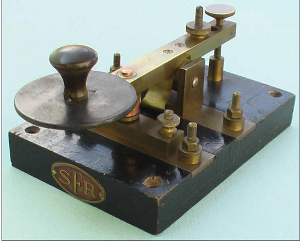
Manipulateur morse SFR type MG2 (collection F9WT)
